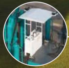
Posisi tiang pancang yang menghadap ke arah kerja saat menggerakkan tiang pancang tengah dan tiang pancang samping untuk mempermudah pengamatan
