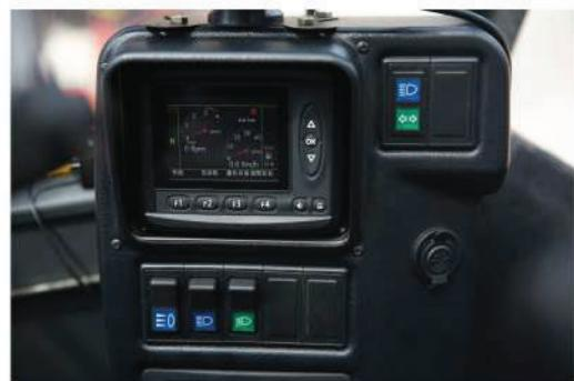
一种高效可靠的系统诊断结果显示工具，起吊重量、起升高度、主系统压力、发动机状态、油位及故障等信息都能一目了然地获取，操作快捷，作业效率高。
