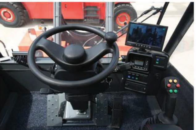
驾驶室采用最新人机工程学设计，简洁大方、宽敞舒适，控制及仪表均触手可及。配置大屏幕彩色显示屏，便于驾驶员实时掌握设备状态。
